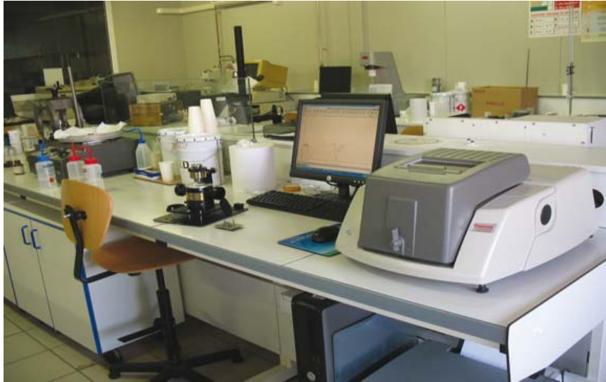
Appareil d'analyse infrarouge; sur l'écran, spectre de mesure
